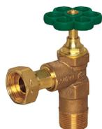
Eckventil für Warm- und Kaltwasser zur Schachtsanierung, DIN-DVGW, mit Außengewinde und Überwurfmutter, mit Plombiermöglichkeit für Wasserzähler, Ausführung: Gehäuse Rotguss, Oberteil aus entzinkungsarmen Material und mit doppelter O-Ring-Abdichtung, Schallschutz nach DIN 52 218: Armaturengruppe 1.
