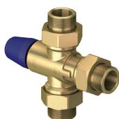
Durch den Einsatz des Moduls kann eine temperaturgeführte Rücklaufeinschichtung realisiert werden und damit im Zirkulationsbetrieb eine Temperaturdurchmischung im Pufferspeicher vermieden werden. Das Modul wird im Rücklauf zwischen Frischwasserstation und Pufferspeicher installiert.
