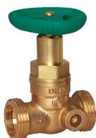
Außengewinde für Metallrohrverschraubungen, einfache Gewindegröße für den Einsatz von Lötverschraubungen, Außengewindeverschraubungen, Pressverschraubungen u. a. Oberteil mit nichtsteigender Spindel, DIN-DVGW, Schallschutz nach DIN 52218: Armaturengruppe 1.
