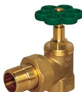
Eckventil für Warm- und Kaltwasser zur Schachtsanierung, Muffe - Tüllenverschraubung für Stahlrohranschluss, Oberteil mit doppelter O-Ring-Abdichtung, Schallschutz nach DIN 52 218: Armaturengruppe 1.
