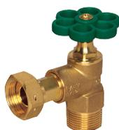
Eckventil für Warm- und Kaltwasser zur Schachtsanierung, DIN-DVGW, mit Außengewinde und Überwurfmutter, mit Plombiermöglichkeit für Wasserzähler, Oberteil mit doppelter O-Ring-Abdichtung, Schallschutz nach DIN 52 218: Armaturengruppe 1.
